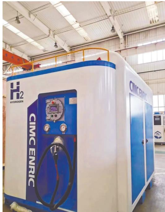
第二代小型撬装式35MPa加氢装置
