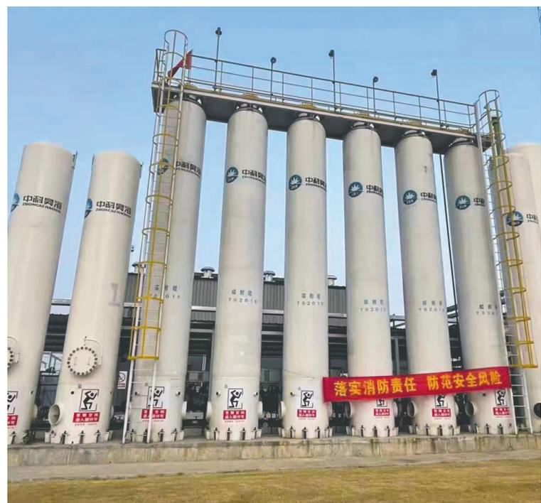
中科富海氢气纯化装置于2022年1月16日一次开车成功,产出的氢气纯度高达99.999%,同时满足国标高纯氢和燃料电池氢的质量要求。与此同时,1.5T/d氢气液化装置目前正在加紧建设中,预计2022年中旬可产出合格液氢。图为氢气PSA纯化回收装置。(中科富海供图)
